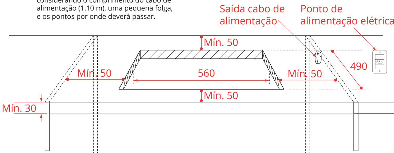
A distância mínima entre a parte inferior dos móveis, ou do exaustor colocado sobre o cooktop, deve ser no mínimo de 700 mm. Se as instruções de instalação do exaustor indicarem uma distância superior, esta deve ser respeitada.
