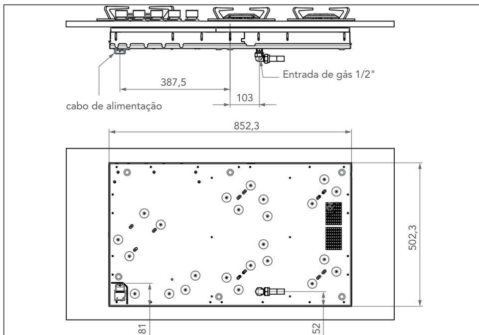
Utilize mangueira metálica flexível (1/2" rosca) gás, conforme norma NBR 14177 (1,2 m de comprimento máximo permitido). Regulador de pressão de gás GLP com registro de saída com rosca externa de 1/2" BSP, conforme norma NBR 8473. Luvas e niple para as conexões.
