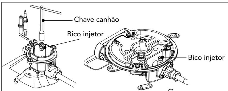
Depois de fazer as referidas substituições, o técnico deverá realizar o ajuste dos queimadores conforme descrito acima, lacrar os eventuais dispositivos de ajustes ou pré-regulação e aplicar no produto, em substituição ao existente, a etiqueta que corresponde à nova regulação do gás efetuada no produto. Esta etiqueta encontra-se no envelope dos injetores de substituição.
