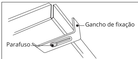
Para evitar possíveis contatos acidentais com a superfície do cooktop superaquecido durante o seu funcionamento, é recomendável instalar uma separação de madeira fixada por parafusos a uma distância mínima de 70 mm do tampo do móvel.
