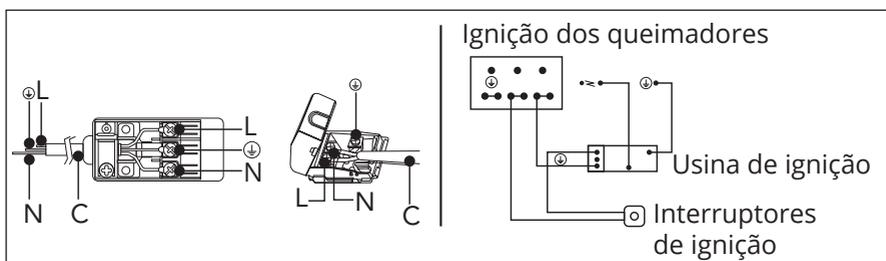
Se for necessário efetuar modificações na instalação elétrica existente ou se a tomada não for compatível com as especificações, todas as alterações deverão ser efetuadas por profissional qualificado. Em particular, deve-se verificar a bitola dos fios.
