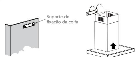
**NOTA:** As duas aberturas de ventilação, com diâmetro de 6 mm, estão localizadas na parte superior do duto. Direcione o tubo de exaustão para a saída na parede e fixe-o com a braçadeira.
