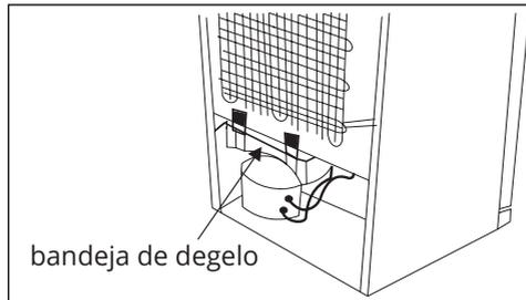
O Freezer realiza a descongelamento automático. A água resultante do descongelamento passa pela calha de recolhe de água, flui para a bandeja de degelo atrás do Freezer e evapora-se.
