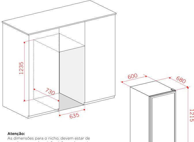
As dimensões para o nicho, devem estar de acordo com as descrições informadas neste gabarito. Devem ser observadas as dimensões minímas de espaço necessárias para a instalação da adega.
