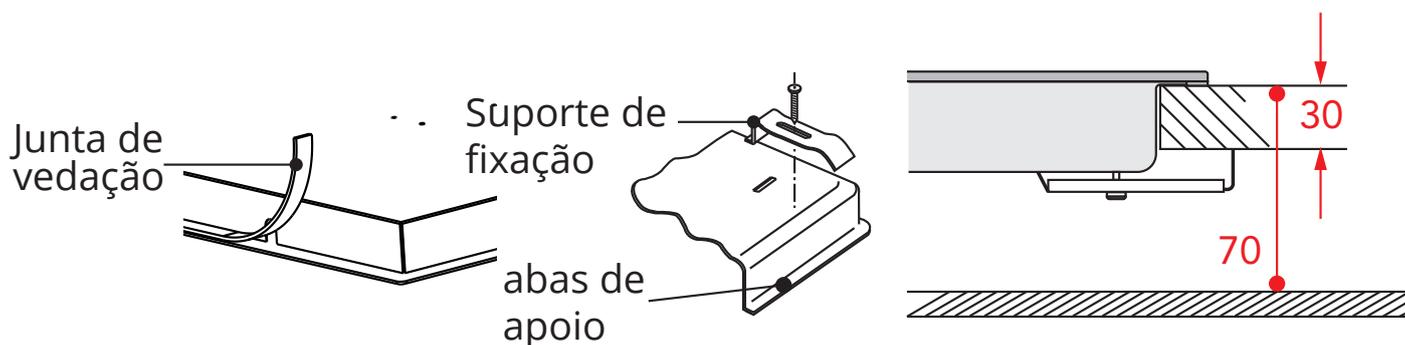
Retire todas as partes móveis do Cooktop, corte a junta de vedação em 4 partes no comprimento necessário para aplicá-la nas 4 bordas. Após encaixar o Cooktop no recorte feito no móvel, fixe-o utilizando os suportes de fixação com os parafusos correspondentes.
