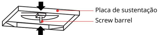
Insira o screw barrel na placa de sustentação e utilize 2 parafusos M10 de porcas para fixar o screw barrel na placa de sustentação na posição superior e inferior. Certifique-se de que o screw barrel não esteja mais alto do que o topo da placa de sustentação.
