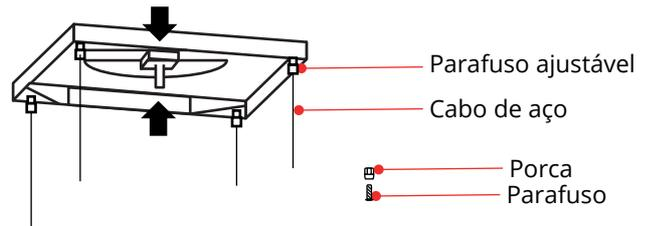
Instale os 4 parafusos ajustáveis para a placa de sustentação, parafuse para o comprimento adequado e não deixe muito apertado.
