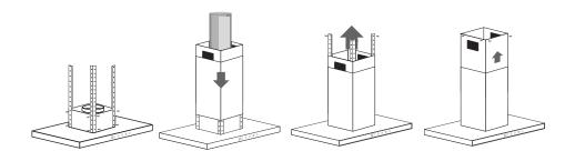
Encaixe o tubo flexível no furo de 170 mm.
