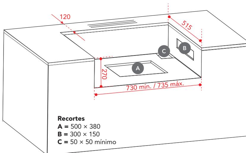
O cilindro (botijão) de gás e o sobressalente não devem ser armazenados diretamente sob a churrasqueira, instale-o a direita da churrasqueira, em caso de armazenamento em uma subestrutura, observe as seguintes instruções de instalação:
