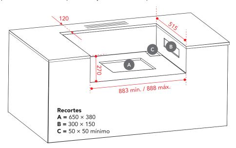
O cilindro (botijão) de gás e o sobressalente não devem ser armazenados diretamente sob a churrasqueira, instale-o a direita da churrasqueira, em caso de armazenamento em uma subestrutura, observe as seguintes instruções de instalação:
