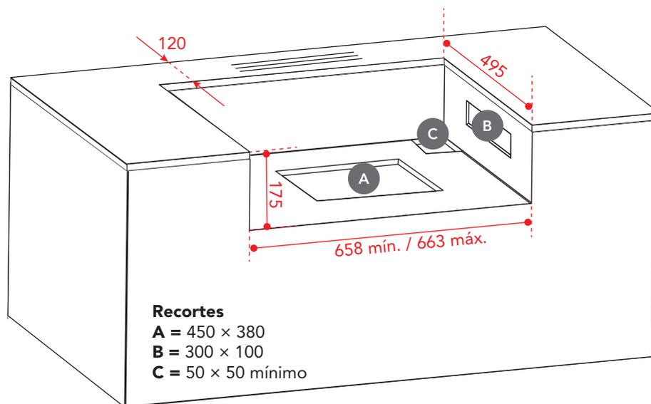
**Nicho de instalação do cilindro (botijão) de gás. A porta deve ser sem trava.**
