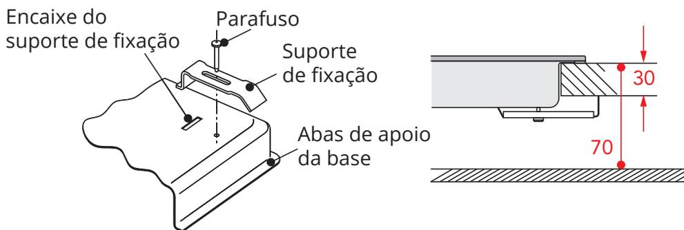
Após encaixar o cooktop no recorte feito no móvel, fixe-o utilizando os suportes de fixação com os parafusos correspondentes.
