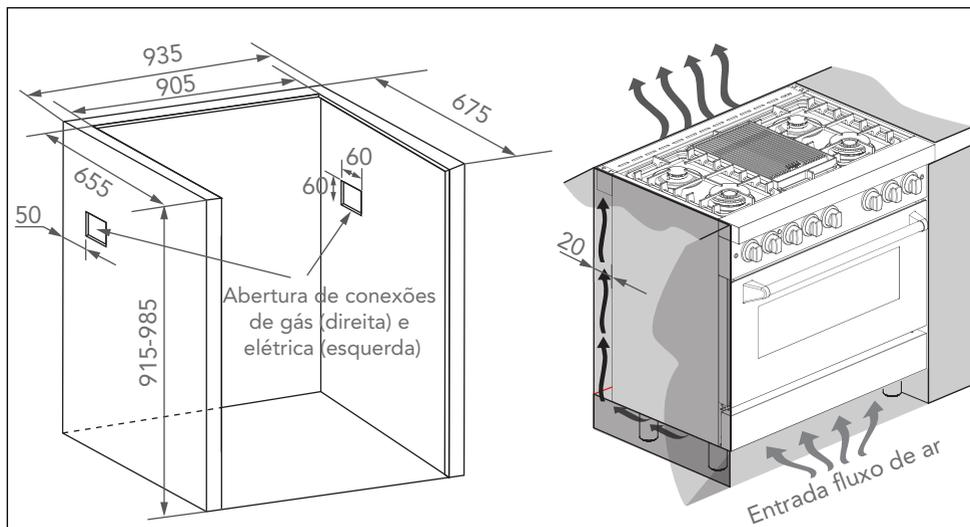
Recomendação de nicho, para instalação com a remoção dos pés de apoio.
