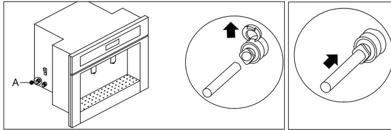
**NOTA:** Instale um registro para a interrupção do abastecimento de água em local de fácil acesso, para quando for necessário a manutenção ou reparo do produto ou de suas conexões de abastecimento.
