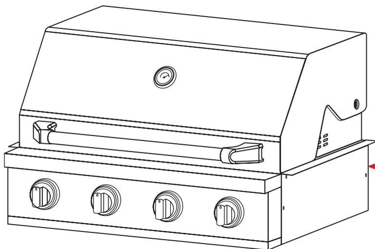
O produto é equipado com um tubo metálico flexível com porca de conexão 3/8" cônica, localizado no lado direito na parte traseira, para conexão de gás.
