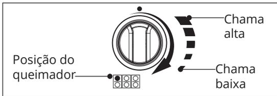
**NOTA:** Quando um queimador for colocado na posição "Chama alta", os acendedores do queimador irão produzir faíscas. Não tente desmontar ou limpar em torno de qualquer queimador enquanto outro queimador estiver ligado. Não toque em qualquer capa (espalhador) de queimador, base de queimador, ou ignitor, enquanto os ignitores estiverem produzindo faíscas.
