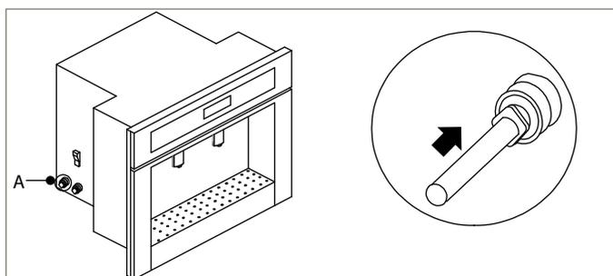
Tubo PE conectado aos conectores rápidos do dispenser. Pronto para o tubo PE, o tubo PE deve ser cortado nas duas extremidades, puxado por um encaixe rápido de fonte azul.
