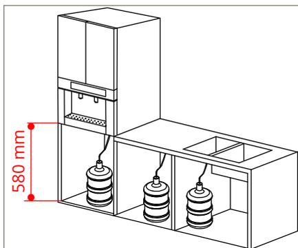
Rompa o lacre da galão de água. O tubo PE com uma extremidade do conector, a outra extremidade do conector uma mangueira de silicone. O conector Tubo PE inserido na saída do galão. A conexão da galão de água pode ser colocada no gabinete de pia ou no gabinete alto, conforme figura.
