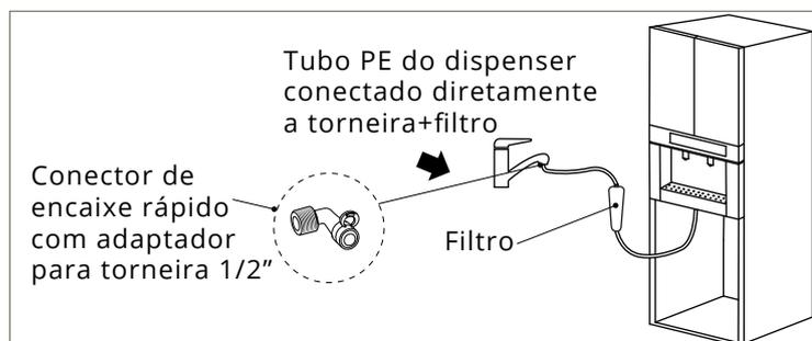
As conexões do purificador de água e do dispensador de água. O tubo PE conectado à porta do dispenser está diretamente conectado ao purificador de água, conforme figura.
