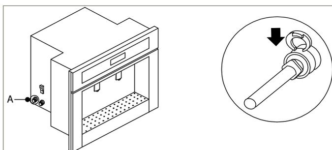
Insira o encaixe nos espaços vazios entre o conector e o anel de encaixe para obter requisitos de conexão firmes.
