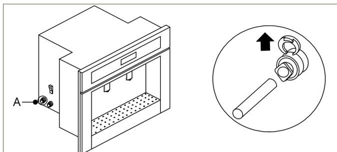
O anel elástico da inserção do tubo PE, deve ser firmemente inserido no final e, em seguida, use a força apropriada para puxar o tubo PE para verificar a fixação na conexão, para que não haja desconexão.
