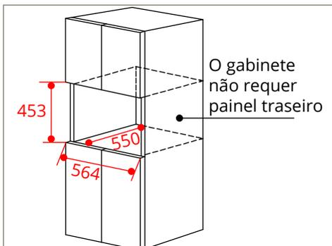
O gabinete deve possuir bons requisitos de espaço de dissipação de calor, instalação de gabinetes sem painel traseiro, conforme mostrado no diagrama.
